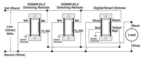
NOTE: DDL06, DDMX1, DDE06, DD710, DW6HD, DW1KD, DH6HD, DH1KD, DZ6HD, DZ1KD, DL6HD and DL1KD are compatible with DD00R-DLZ.
