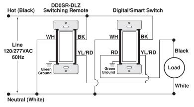
NOTE: DDS15, DW15S, DH15S, DZ15S and DL15S are compatible with DD0SR-DLZ.
