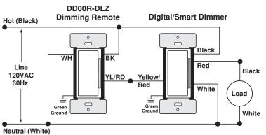
NOTE: DDL06, DDMX1, DDE06, DD710, DW6HD, DW1KD, DH6HD, DH1KD, DZ6HD, DZ1KD, DL6HD and DL1KD are compatible with DD00R-DLZ
