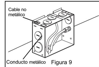
Cable no metálico Conducto metálico Figura 9
