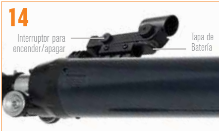
14 Saque la pequeña pestaña de plástico bajo la tapa de la batería tirando de ella. Para conservar batería, asegúrese de apagar el localizador cuando no lo use.
