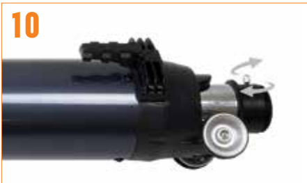
10 Afloje el tornillo del enfoque. Saque la tapa de plástico que cubre el extremo del enfoque.
