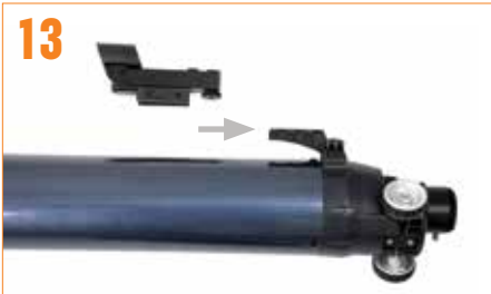
13 Afloje los dos tornillos de cabezal Philips en el lateral del localizador y deslice la abrazadera sobre el soporte machihembrado. Asegure el localizador en posición apretando los dos tornillos de cabezal Philips.
