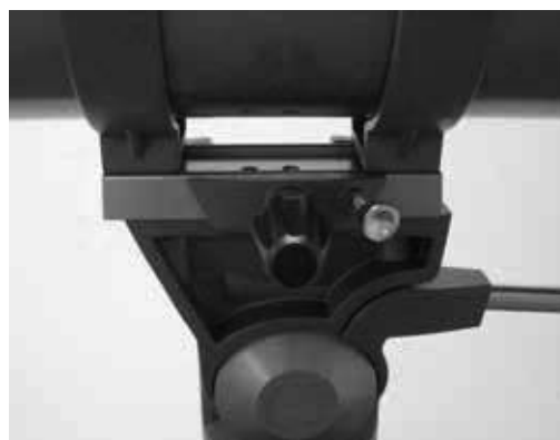
Fig. 2-12 Molette de montage et vis de sécurité dans la platine pour queue d'aronde
