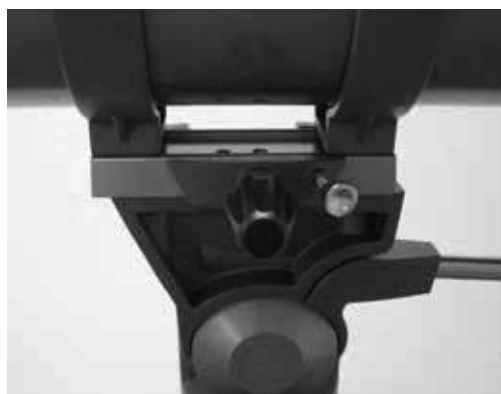
Fig. 2-12 Manopola di montaggio e vite di sicurezza nella staffa a coda di rondine
