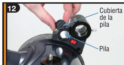
Desenrosque la cubierta de la pila del buscador del telescopio StarPointer. Introduzca la pila con el lado "+" hacia afuera.
