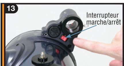
Remettez le couvercle de pile et serrez. Pour augmenter la longévité de la pile, n'oubliez pas d'éteindre le chercheur lorsqu'il n'est pas utilisé.
