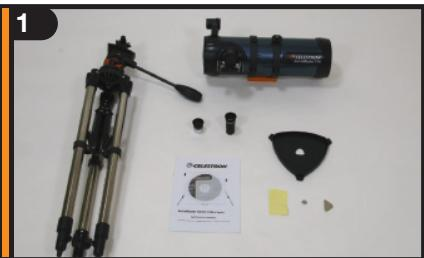
Votre AstroMaster 114AZ comprend : un tube optique avec chercheur StarPointer intégré, un trépied pré-assemblé avec support central et monture altazimutale jointe, deux oculaires, un réceptacle à accessoires, une pile, un manuel de l'utilisateur, et un CD du logiciel The Sky™.
