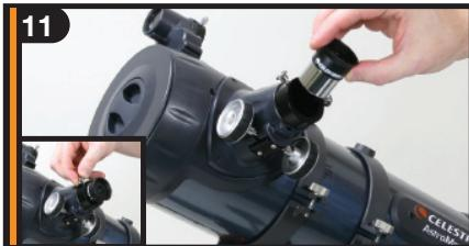
Inserire il barilotto cromato dell'oculare da 20 mm nel focheggiaore e serrare la vite.
