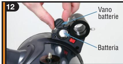
Svitare il vano batteria per il cercatore StarPointer. Inserire la batteria in il lato "+" rivolto verso l'esterno.
