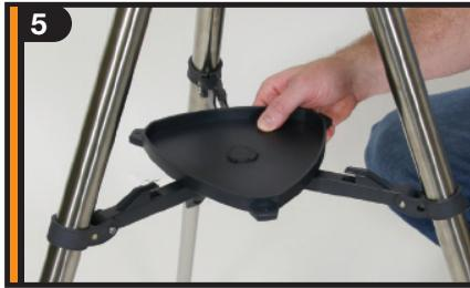
Zur Befestigung der Zubehörablage die Kerben ausrichten und eine Drehung im Uhrzeigersinn vornehmen, bis die Ablagetaschen in die Stativhalterungen einrasten.
