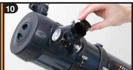
Die Stellschraube am Okularauszug losdrehen. Den Plastikdeckel, mit dem das Ende des Okularauszugs geschützt ist, entfernen.
