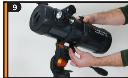
Centre la ensambladura a cola de milano en el montaje y apriete el tornillo de sujeción. Para agregar más seguridad apriete en ángulo el tornillo de bloqueo, el cual está situado junto al tornillo de sujeción.
