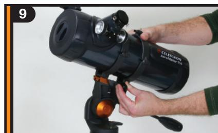
Den Schwalbenschwanz in der Montierung zentrieren und die Befestigungsschraube anziehen. Für zusätzliche Sicherheit die abgewinkelte Verriegelungsschraube neben der Befestigungsschraube anziehen.
