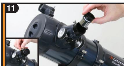
Insérez le barillet chromé de l'oculaire de 20 mm dans le dispositif de mise au point et serrez la vis de blocage.
