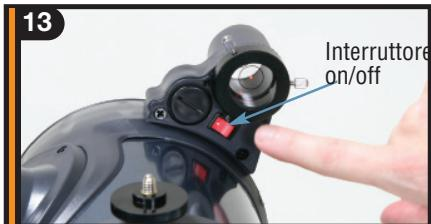
Riposizionare il vano batteria e fissare. Per una maggiore durata della batteria, assicurarsi di spegnere il cercatore se non in uso.
