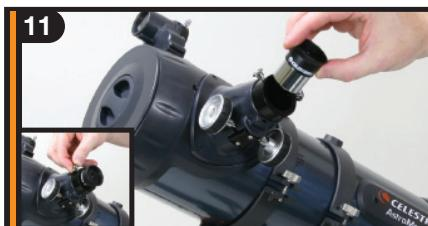
Die verchromte Steckhülse des 20 mm Okulars in den Okularauszug stecken und die Stellschraube festziehen.
