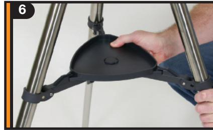
Bei richtigem Zusammenbau sollte die Zubehörablage wie im Bild oben eingesetzt sein.
