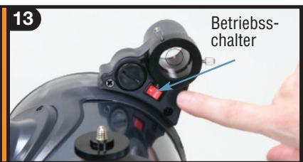
Batterieabdeckung wieder anlegen und festschrauben. Für längere Batterielebensdauer das Finderscope bei Nichtbetrieb ausschalten.
