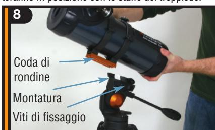
Poi, far scorrere il tubo del telescopio nella montatura. Assicurarsi di allentare le viti di fissaggio per lasciare abbastanza spazio alla coda di rondine.
