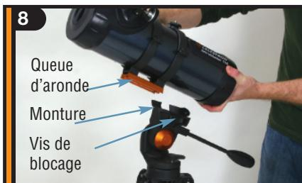
Ensuite, glissez le tube du télescope dans la monture. Veillez à reculer les vis de blocage pour laisser un dégagement suffisant à la queue d'aronde.
