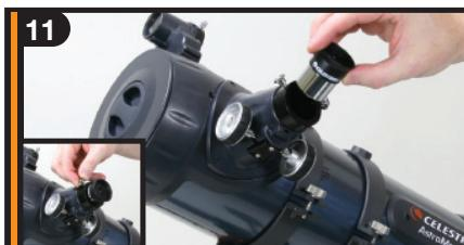
Inserte el tambor cromado del ocular de 20 mm dentro del mecanismo de enfoque y ajuste el tornillo de fijación.
