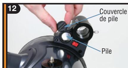
Dévissez le couvercle de pile du chercheur StarPointer. Insérez la pile avec le signe « + » dirigé sur l'extérieur.
