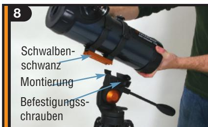
Nun das Teleskoprohr in die Montierung schieben. Die Befestigungsschrauben so weit herausfahren, dass genug Spielraum für den Schwalbenschwanz ist.
