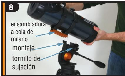
A continuación deslice el tubo del telescopio dentro del montaje. Los tornillos de sujeción deberán ajustarse de forma que quede suficiente espacio para la ensambladura a cola de milano.
