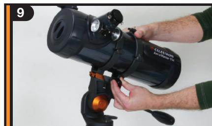
Centrez la queue d'aronde sur la monture et serrez la vis de fixation. Pour plus de sécurité, bloquez le dispositif de verrouillage coudé situé à côté de la vis de fixation.
