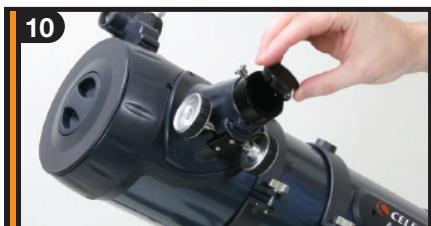
Afloje el tornillo de colocación sobre el mecanismo de enfoque. Saque la tapa plástica que cubre el extremo del mecanismo de enfoque.
