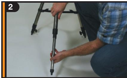
Zum Aufbau des Stativs die Beine nach außen ziehen, bis sie vollständig ausgezogen sind. Alle drei Stativbeine ca. 15 - 30 cm nach unten ausfahren.
