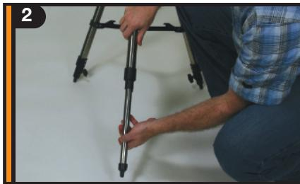
Para ensamblar el trípode, separe las patas hacia afuera hasta que estén totalmente extendidas. Extender cada pata del trípode de 15 a 30 cm (6 a 12 pulgadas).
