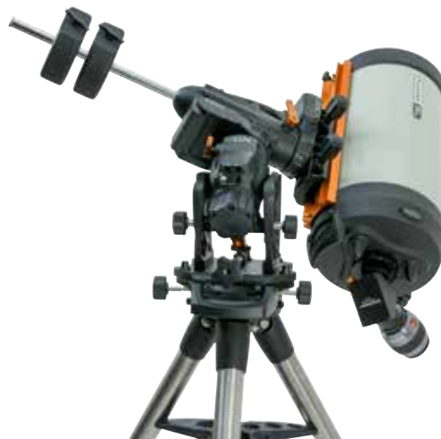
Figura 9.1 Un lato del limite meccanico di AR
