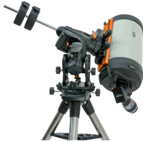
Figura 9.1 Un lado del límite mecánico R.A.
