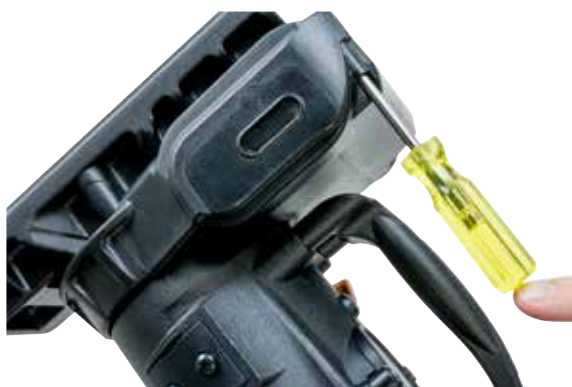
Figura 12 Rimozione della copertura della vite
