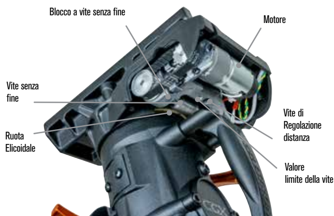
Figura 13 Ingranaggio a vite senza fine
