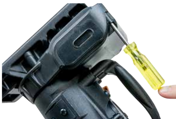
Figura 12 Retirar la tapa del engranaje
