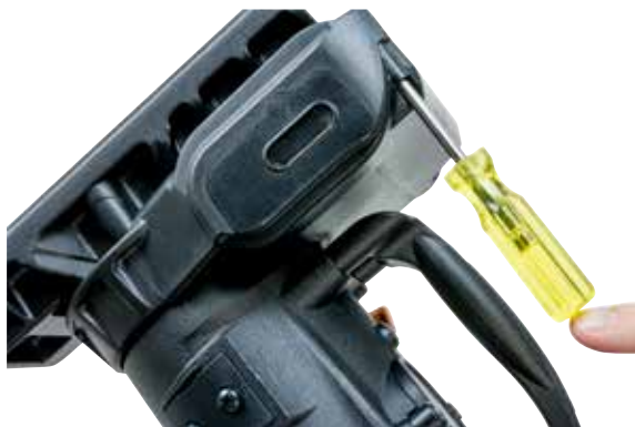
Figure 12 Retirer le cache d'engrenage
