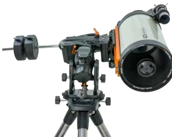
Figura 9.2 Un lato del limite meccanico di DEC
