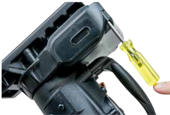
Abbildung 12 Entfernen der Getriebeabdeckung
