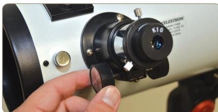
13. Faites la mise au point de votre télescope en faisant tourner les deux molettes situées sous l'oculaire jusqu'à ce que vous obteniez une image nette.
