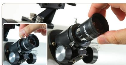
8. Den Chromzyylinder des Okulars in den Fokussierer einführen und mit den Stellschrauben sichern..
