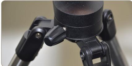
11. Afloje el mando para liberar el eje de azimut (izquierda y derecha).
