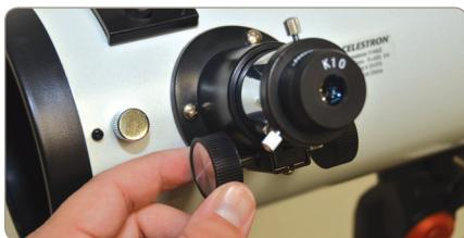
13. Mettere a fuoco il telescopio ruotando le due manopole sotto all'oculare fino a ottenere un'immagine nitida.
