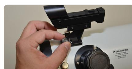
4. Ora, far scorrere la barra di montaggio a coda di rondine sulla parte inferiore del tubo ottico sul gruppo del morsetto sulla parte superiore della montatura. Assicurarsi di allentare le viti di fissaggio per lasciare spazio sufficiente per la barra a coda di rondine.
