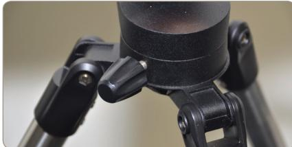
11. Desserrez la molette de verrouillage pour libérer l'axe azimuthal (gauche & droite).
