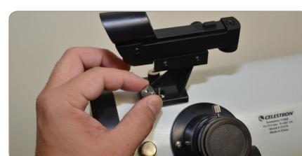
4. Deslice la barra con el tornillo en mariposa de la parte inferior del tubo óptico en la estructura de enganche de la parte superior del soporte. Asegúrese de hacer retroceder el tornillo de fijación para dejar un espacio suficiente para la barra con el tornillo en mariposa.
