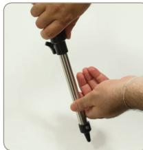
2. Das Stativ wird aufgestellt, indem die Beine vollständig nach außen gespreizt werden. Zum Einstellen der gewünschten Höhe werden die Knöpfe an den Beinenden gelöst. Zum Feststellen der Beine werden die Knöpfe angezogen.
