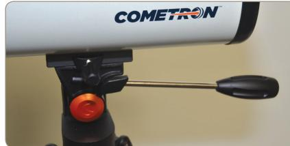
12. Ruotare la manopola panoramica della montatura in senso antiorario per allentare la frizione dell'altitudine (su e giù). Utilizzare la manopola panoramica per spostare il telescopio fino a quando l'obiettivo apparirà nel cercatore di stelle. Una volta centrato l'obiettivo nel campo visivo dell'oculare del telescopio, serrare il dado di blocco dell'altitudine.
