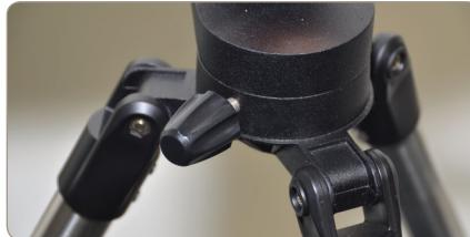
11. Allentare la manopola della frizione per liberare l'asse dell'azimuth (sinistra e destra).
