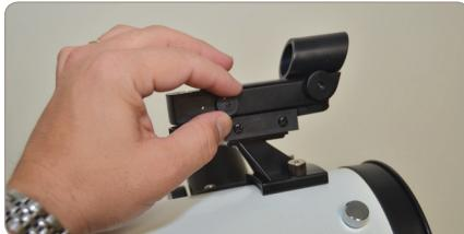
10. Mettez sous tension le chercheur à points rouges. Pour préserver la durée de vie de la pile, assurez-vous de le mettre hors tension lorsque vous ne l'utilisez pas.
