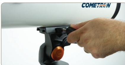
5. Die Schwanenschwanzführung wird in der Montierung zentriert, und die Schraube wird angezogen.
