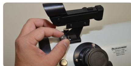
6. Zum Anbringen des Suchers werden die Muttern seitlich am Tubus entfernt, die Halterung wird über den Gewinden platziert und die Muttern wieder angebracht.
