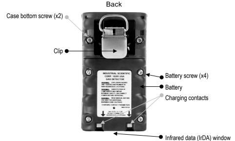
Figure 3.1.A Hardware overview diffusion instrument
