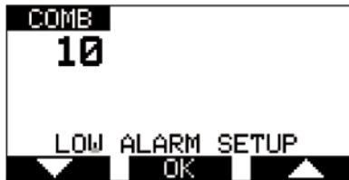
Figura 3-6. Configuración de una alarma de sensor
