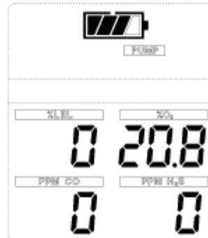
Figura 3-3. Alarma de la bomba mostrada en pantalla
