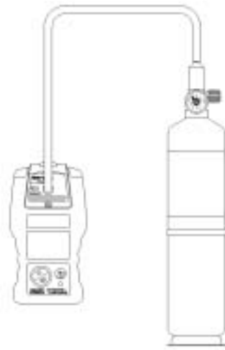
Figure 5-4. Montage de calibrage typique – pour unité à diffusion avec capuchon de calibrage
