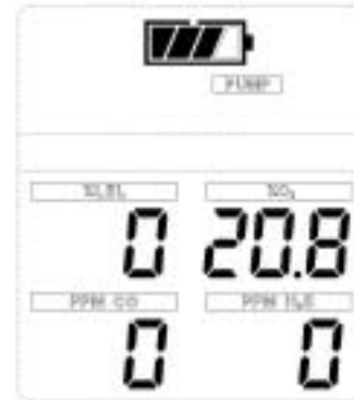
Figure 3-3. Alarme de pompe
