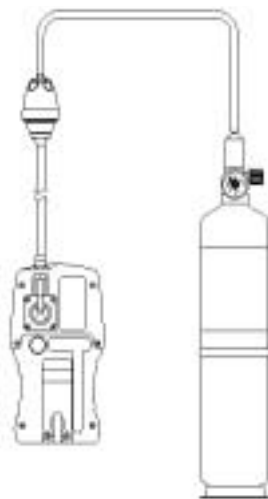
Figura 5-4. Ajuste de calibración típica para las versiones con bomba
