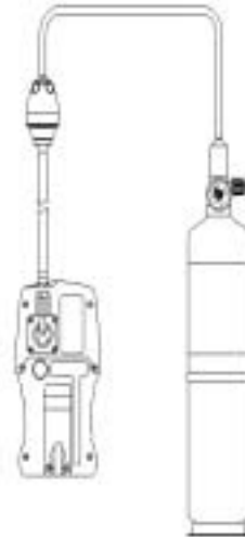
Figure 3-4 Détecteur Orion G avec tube d'étalonnage
