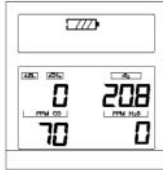
Figura 3-7. Instrumento en alarma de gas tóxico
