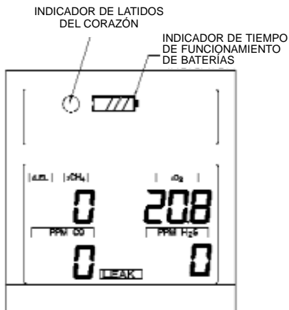
Figura 3-2. Indicadores de latidos del corazón y tiempo de funcionamiento de baterías
