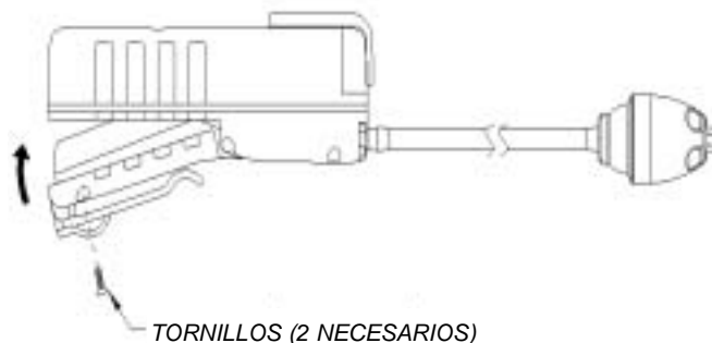
Figura 3-1. Instalación del paquete de baterías
