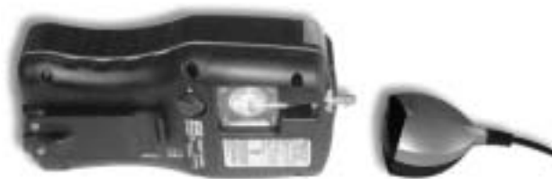
Figure 5-5. Raccordement de l'adaptateur infra-rouge à l'instrument
