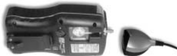
Figura 5-5: Acople del adaptador infrarrojo al instrumento
