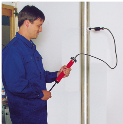
Image 4: Prélever des gaz de fumée
