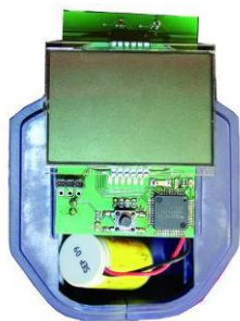
Imm. 45: Remplacement de la pile
