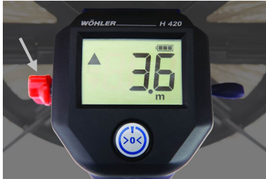
Imm. 53: vite per impostare il freno
