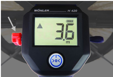
Abb. 8: Sterngriffschraube zum Einstellen der Freilaufbremse
