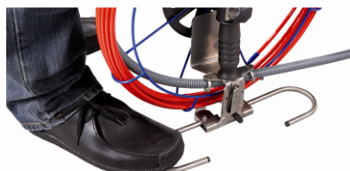
Imm. 41: Fixer le support de l'enrouleur
