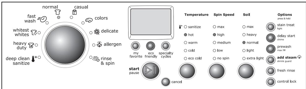
Gire el selector de ciclos en cualquier dirección para seleccionar el ciclo deseado. Se iluminará el indicador del ciclo seleccionado. Oprima la perilla de selección de ciclo para extenderla o para que quede al ras de la consola.
